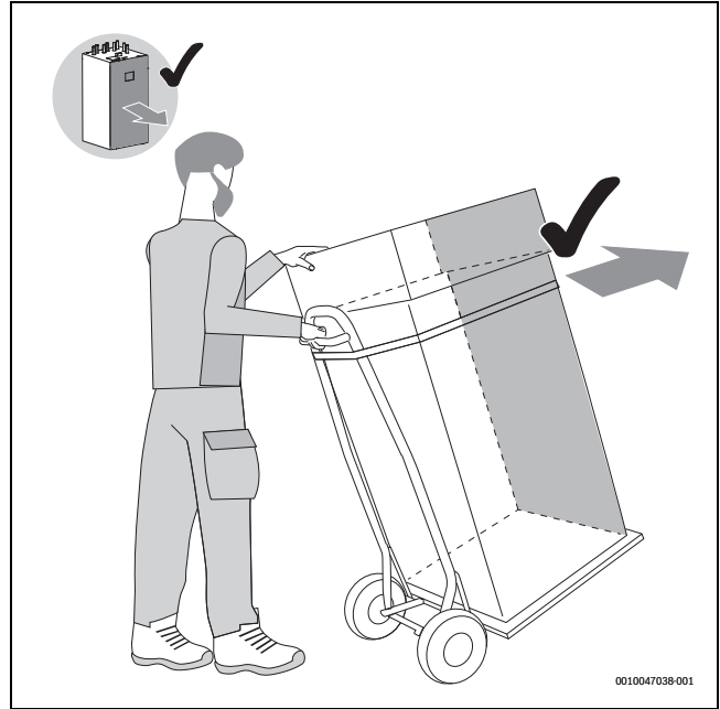
Bild 9 Inneneinheit mit einer Sackkarre transportieren
