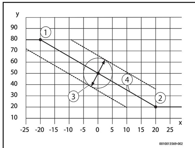
Bild 5 Außentemperaturgeführte Heizkurve
