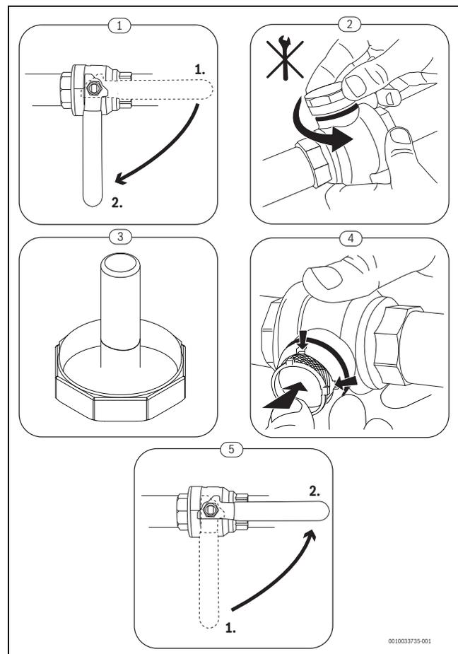
Bild 5 Siebreinigung
