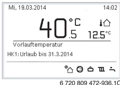
Wenn 2 oder mehr Heizkreise installiert sind, muss vor der Unterbrechung des Urlaubsprogramms der entsprechende Heizkreis in der Standardanzeige ausgewählt werden.
