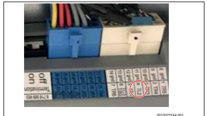
Bild 12 Referenzfühler TL2 an der I/O-Modul-Platine
