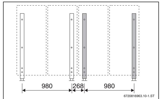
Bild 29 Grundauführung für 2 Kollektoren und Erweiterung für 2 Kollektoren (Maße in mm)
