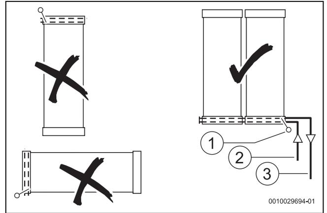
Bild 10 Zulässige Anordnung und Ausrichtung
