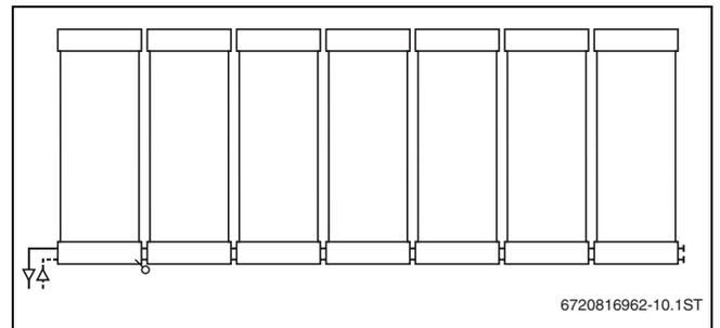
Bild 11 Maximal 7 Kollektoren, gleichseitiger Anschluss rechts oder links (1 Reihe)
