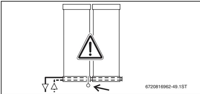
Bild 50 Wenn Vorlauf links, erst Temperaturfühler vorbereiten
