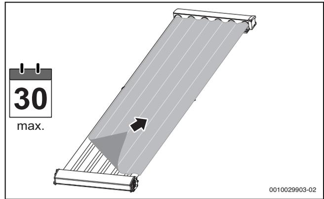
Bild 60 Kollektorfolie entfernen
