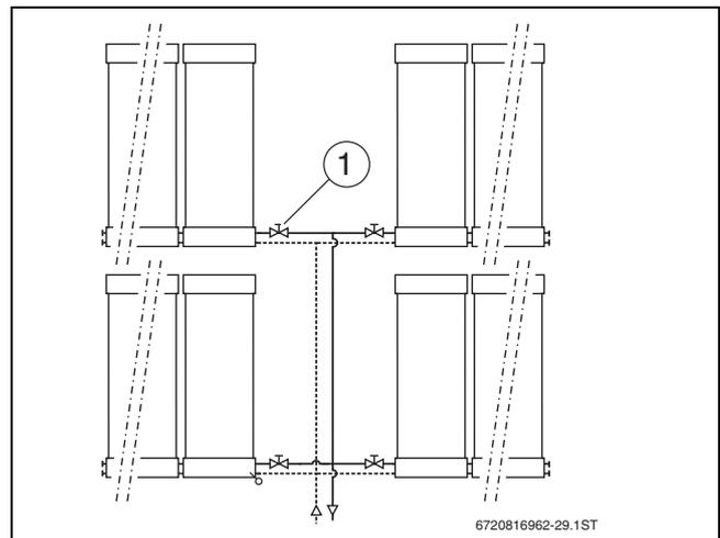
Bild 17 Maximal 7 Kollektoren je Einzelfeld (Parallelschaltung)
