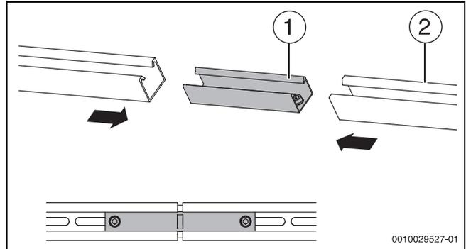
Bild 40 Profilschienen verbinden
