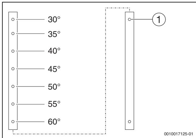
Bild 25 Neigungswinkel über Löcher in der Schiene wählen
