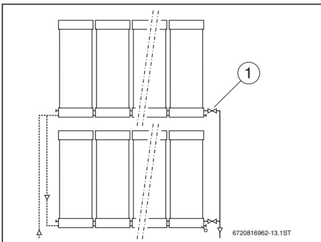
Bild 15 Maximal 14 Kollektoren je Reihe (Parallelschaltung) nach Tichelmann
