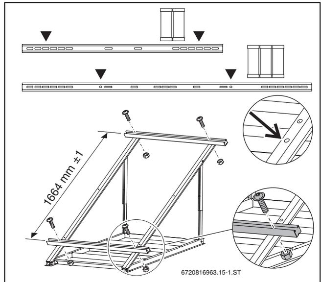
Bild 41 Profilschienen für 2 und 3 Kollektoren montieren
