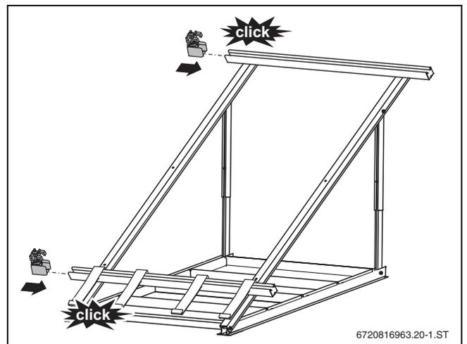
Bild 44 Kollektorspanner montieren
