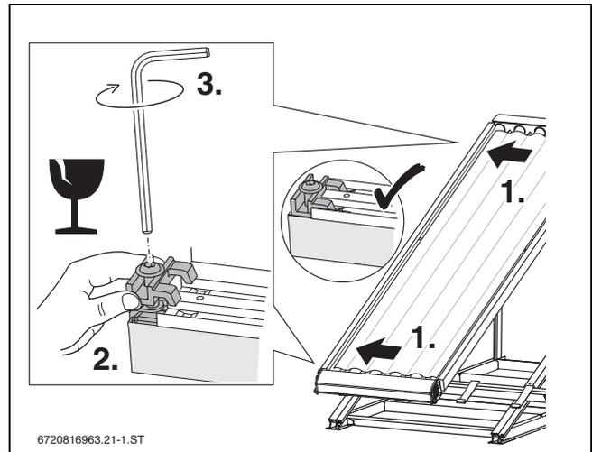
Bild 47 Ersten Kollektor befestigen
