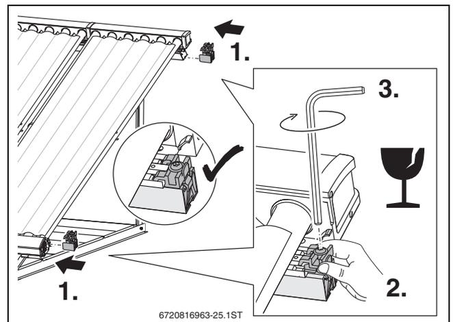
Bild 53 Kollektorspanner montieren
