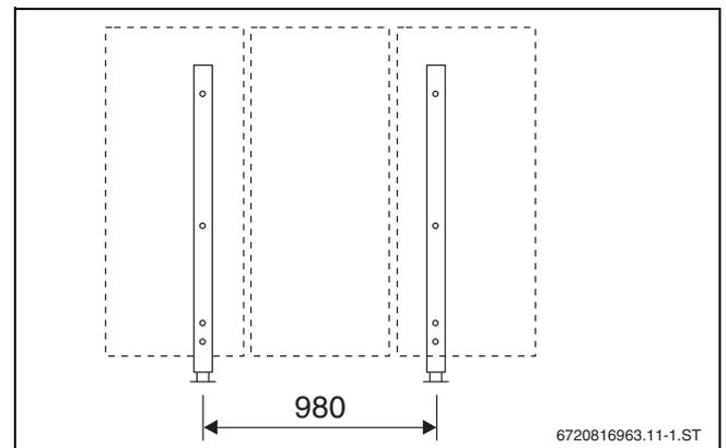
Bild 28 Grundauführung, 3 Kollektoren (Maße in mm)
