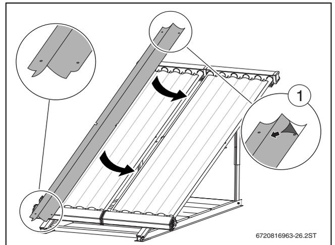
Bild 57 Zwischenspiegel einlegen
