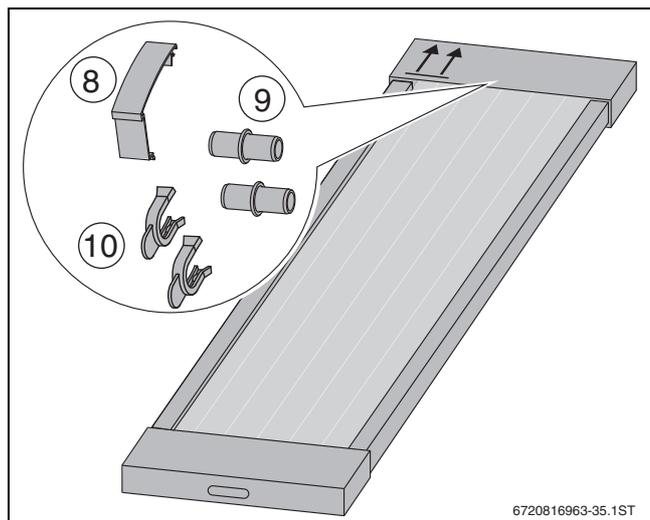
Bild 5 Kollektor mit in der Verpackung liegende Bauteile
