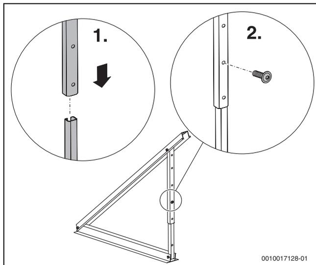
Bild 26 Teleskopschienen montieren
