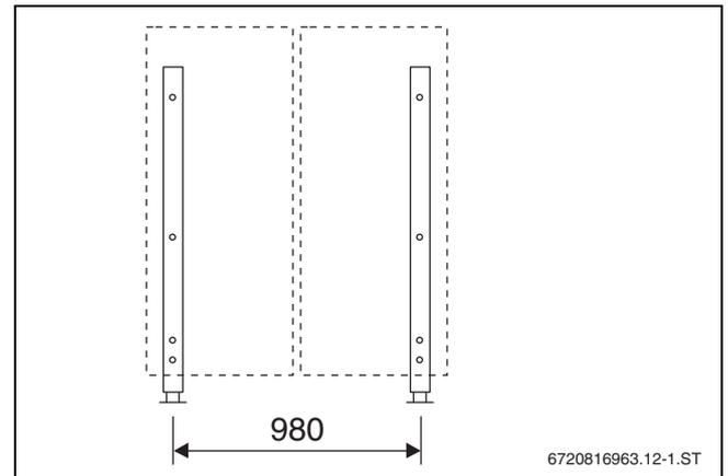
Bild 27 Grundauführung, 2 Kollektoren (Maße in mm)
