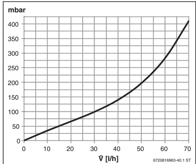
Bild 2 Druckverlust Kollektor (Solarflüssigkeit LS bei 50°C)
