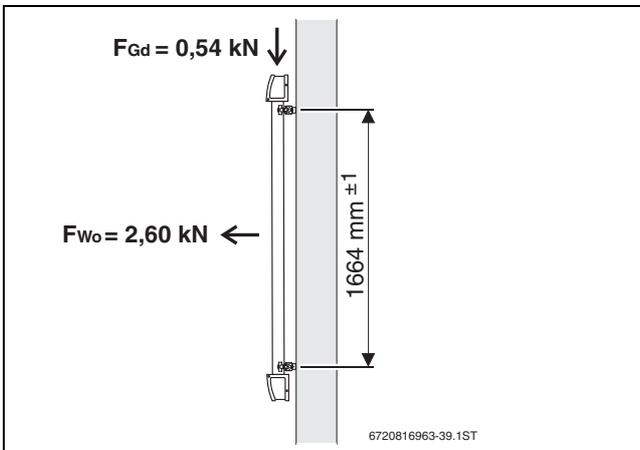
Bild 37 Profilschienen bauseits an der Fassade montieren
